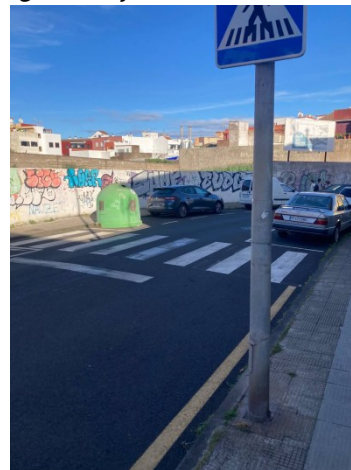
Geneto. Aceras interrumpidas, sin rebajes y firme en malas condiciones. Calle Bocatuerta, Inmediaciones Colegio Echeyde.
